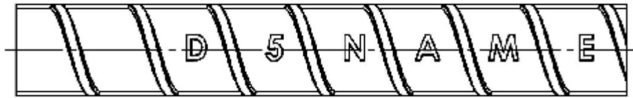
ציור ד3 – סימון המוטות לפי סוג הפלדה – סימון חלופי עבור פ-500D
