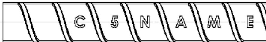
ציור ב-3 – סימון המוטות לפי סוג הפלדה – סימון חלופי עבור פ-500C
